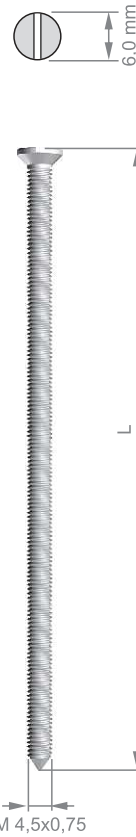
▲ ВИНТ КОЛЕННЫЙ KNEE SCREW M 4,5 x 0,75mm
